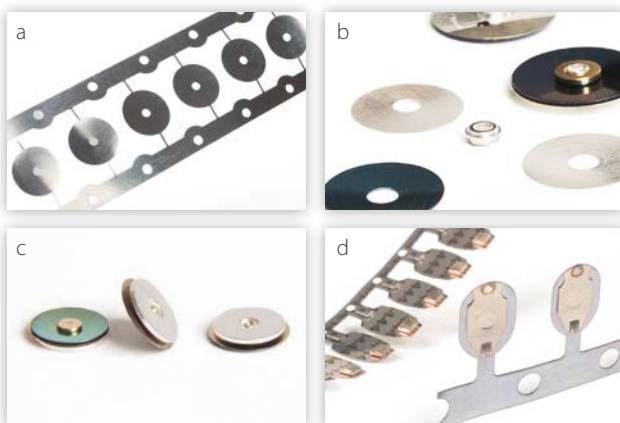
Unverschweißte, d. h. unbeschädigte zentrische Lochscheiben (a) arbeiten aufgrund einer Zusatzmechanik (b, c) kontinuierlich. Werden Bimetallscheiben hingegen verschweißst (d), arbeiten sie immer diskontinuierlich.
