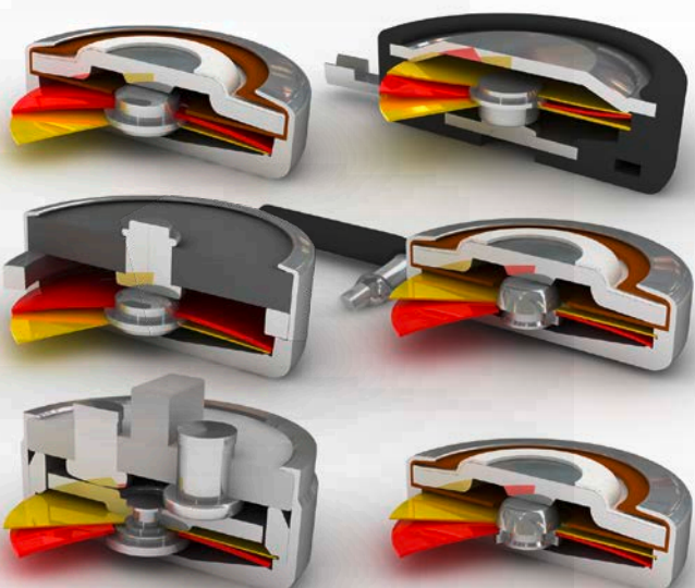
Abb. 6: Automatisch rückstellende und temperatursensitive, öffnende Temperaturbegrenzer mit zusätzlicher Federschnappscheibe (nichtlinearer Verlauf)
