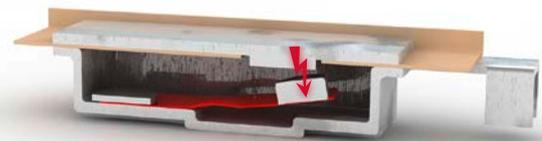
Fig. 3: Limitador de temperatura sin disco elástico adicional. Por esta razón aplicación de contacto muy lenta y peligro de arco voltaico.
