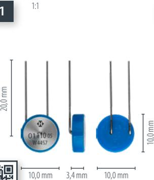
Tipo: Normalmente cerrado, rearme automático; con alambre de conexión; aislamiento parcial en capuchón plástico
