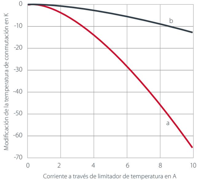
Fig. 2: Calentamiento propio de corriente: comportamiento típico de un limitador de temperatura de corriente intensiva con disco bimetálico (a) atravesado por corriente en comparación a limitadores de temperatura con disco bimetálico (b) no atravesado por corriente.
