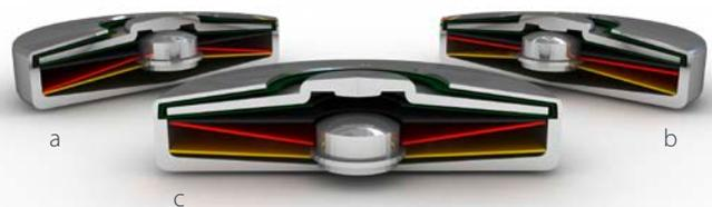
Fig. 2: Función y comportamiento de conmutación de un limitador de temperatura con disco elástico adicional (amarillo), con lo que el disco bimetalico (rojo) puede trabajar de forma continua.
