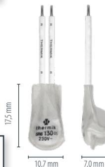
Tipo: Normalmente cerrado, sin rearme automático; con conductores de conexión; con epoxi; aislamiento: Mylar®-Nomex®
