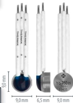
Tipo: Ruptor tripolar para empleo en corriente trifásica en el punto de estrella; rearme automático; con epoxi; sin aislamiento
